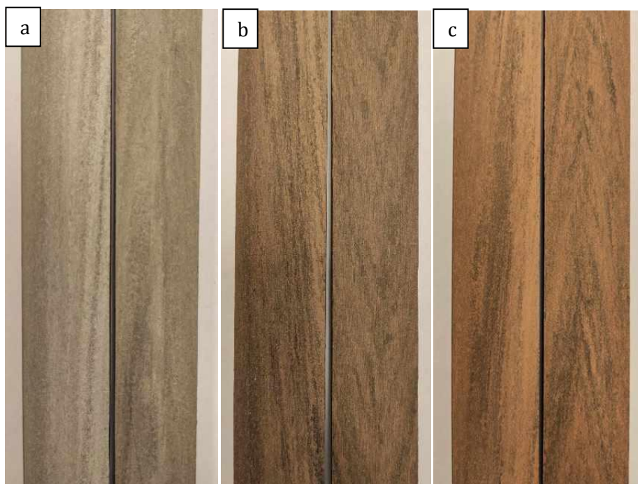
Fot. 1. Widok desek przed (po prawej) i po starzeniu (po lewej) a) kolor szary, b) kolor brązowy, c) kolor pomarańczowy
